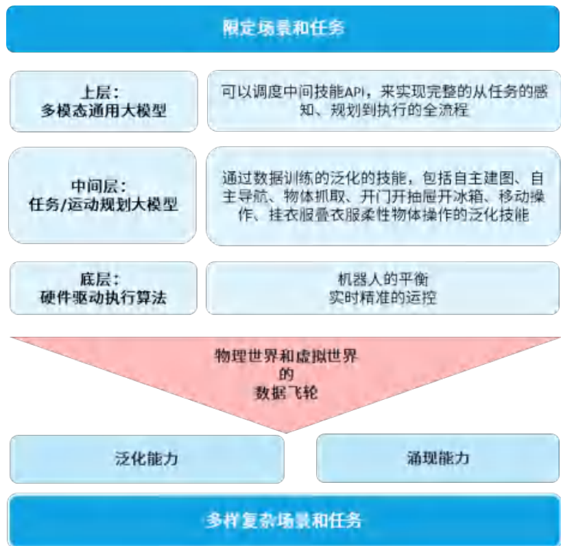
图5: 分层端到端大模型: 从限定场景和任务到多样复杂场景和任务
